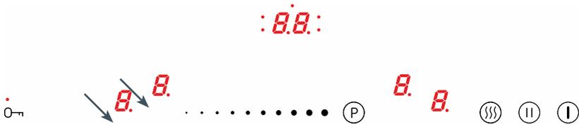
Gracias a la función Bridge podrá controlar 2 zonas de cocción de la placa como una zona de cocción reducida. La función Bridge es muy cómoda, sobre todo cuando se usa para cocer en ollas de tipo asador. La placa tiene la función Bridge para las zonas izquierdas y derechas.
