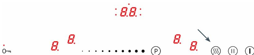
La función de calentar la comida mantiene el calor de alimentos ya preparados colocados en la zona de cocción. La zona de cocción seleccionada está activada con una potencia de calentamiento baja. Gracias a esta función tendrá el plato caliente preparado para comer que no cambia de su sabor y no se pega al fondo de la olla. Además, podrá usar esta función para derretir la mantequilla, el chocolate, etc.
