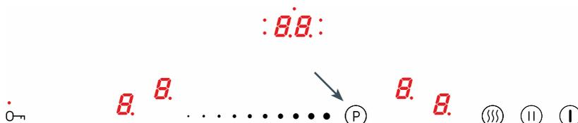
La función Booster aumenta la potencia de la zona de cocción 220x190mm - de 2200W a 3700W, Las zonas Bridge (220x390mm) de 3600W a 5500W.
