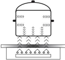
El generador eléctrico alimenta la bobina situada en el interior del aparato.
