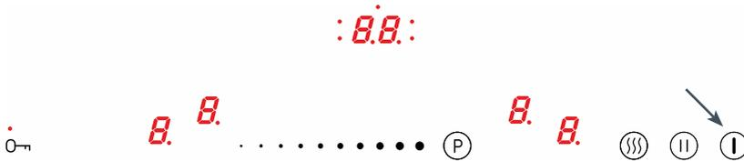
Toque y mantenga con el dedo durante al menos un segundo el sensor activar/ desactivar (I). La placa de cocción señala el funcionamiento correcto (actividad), cuando en el indicador del reloj **8.** aparece el dígito "0".
